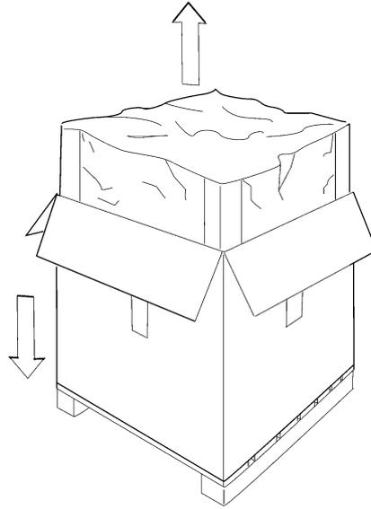
7. Levantar y sacar a la máquina aún envuelta en la bolsa de plástico transparente;
